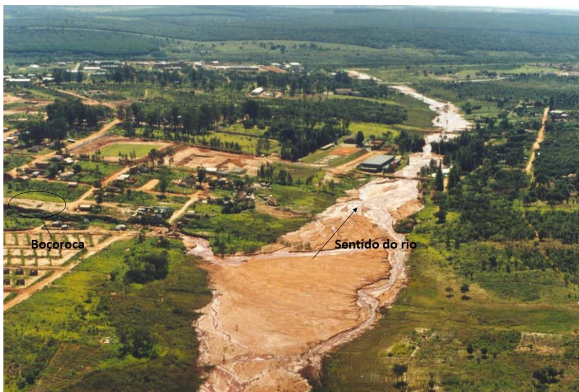
Figura 13 - Assoreamento a jusante de uma boçoroca (Fonte: IPT)
