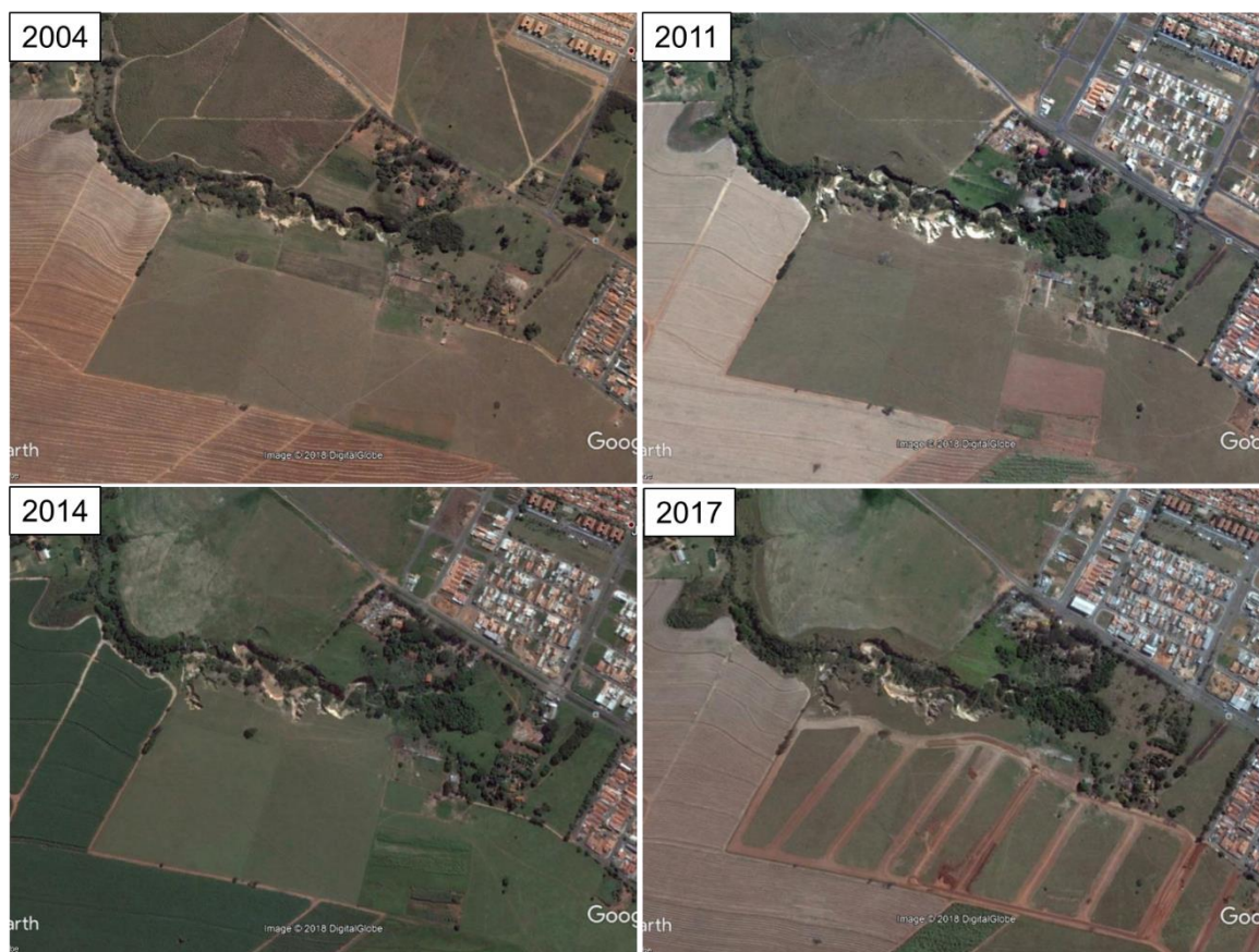
Figura 29 - Infere-se grande evolução da boçoroca entre 2004 e 2011. De 2011 a 2014 não há alterações significativas. E, por fim, de 2014 a 2017 há crescimento de vegetação
